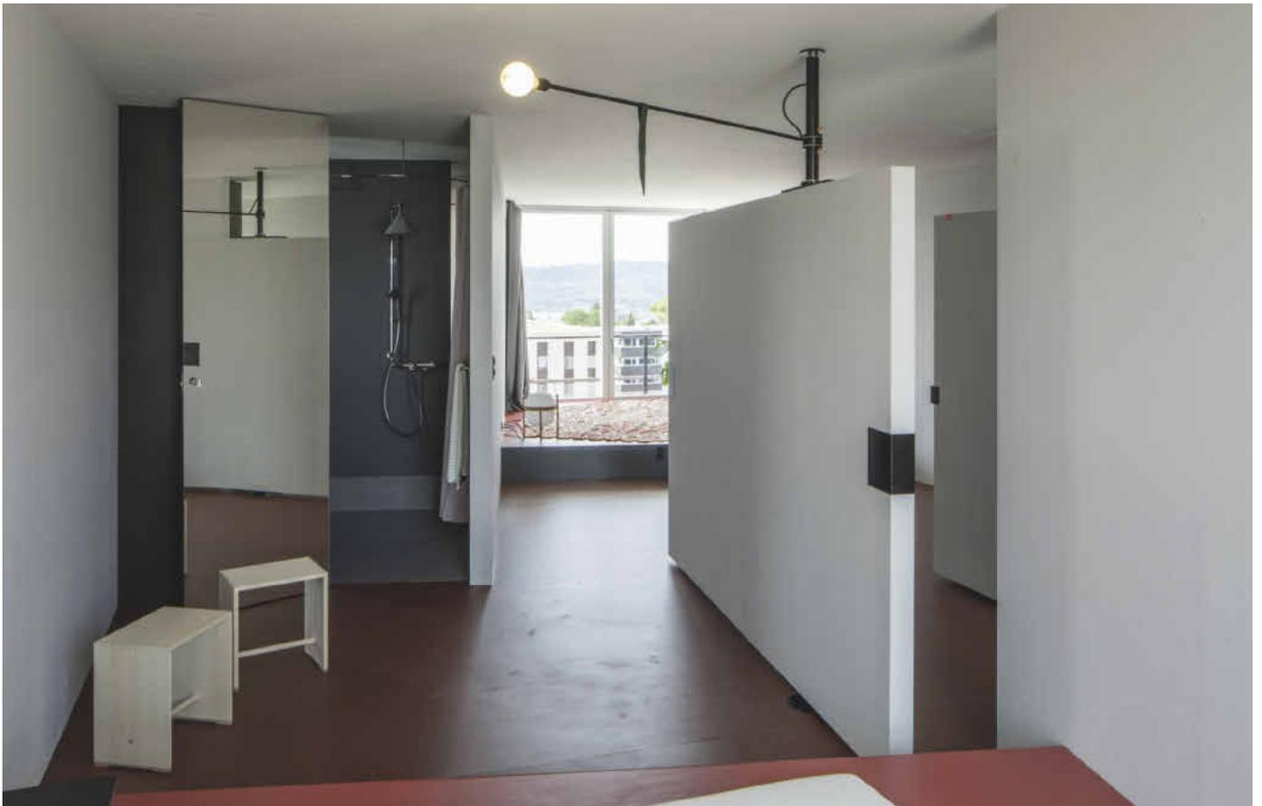
Funktionsfähige Musterwohnung auf 54 m<sup>2</sup> Grundfläche. Das Besondere liegt in diversen beweglichen Elementen: eine drehbar gelagerte Wand, die es erlaubt, Raumteile abzuschließen oder zu öffnen sowie große schwenkbare Leuchten.
