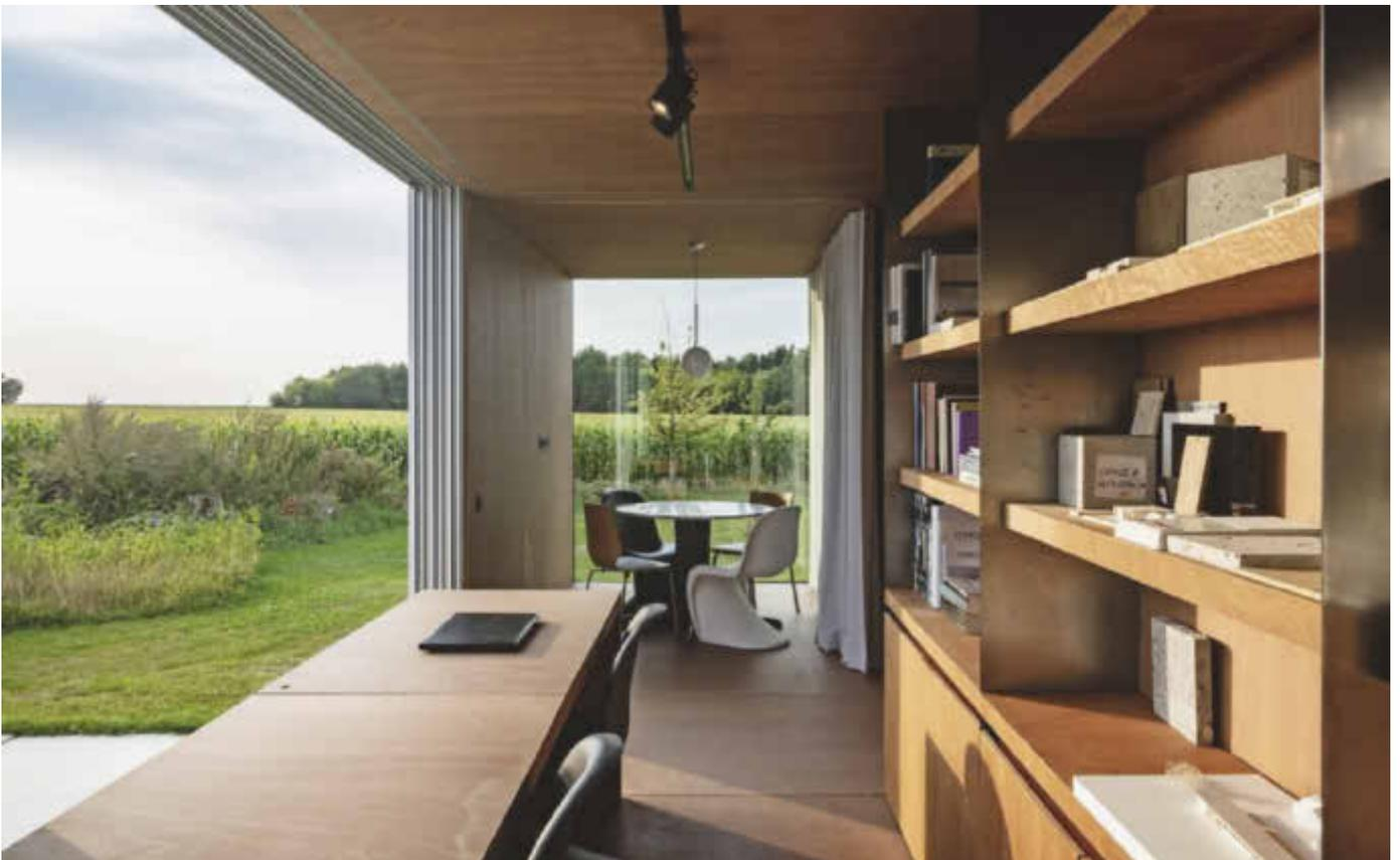
Die Grundmaße der Sperrholzplatten bestimmen die Größe der Schreibtische und der Bücherregale. In den Regalen sitzen sie zwischen vertikalen Stahlbändern. Nichts muss verschraubt werden.
