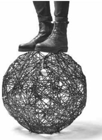
Gewickelte Fasermodule sind äußerst stabil.
