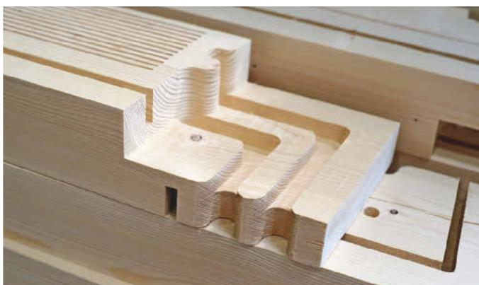
Massivholz-Fichtenbalken mit CNC-gefrästen Details, einschließlich eingesägter Luftkammer zur Isolierung und Materialstabilität.
